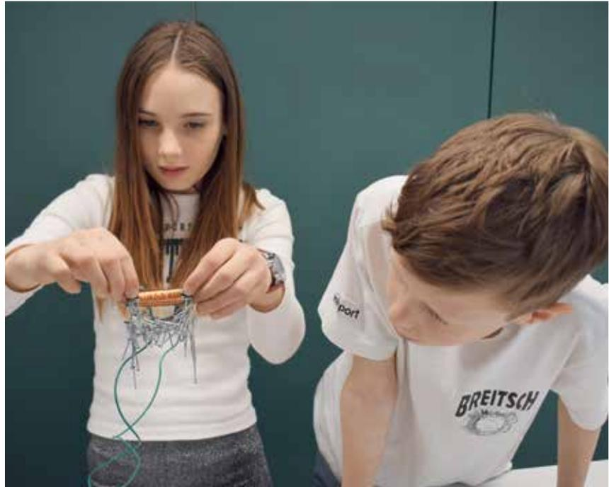
Ein Elektromagnet ist einfach herzustellen: Unter anderem braucht es Kupferlackdraht, eine Metallschraube, Prüfkabel und drei Akkus dazu.
